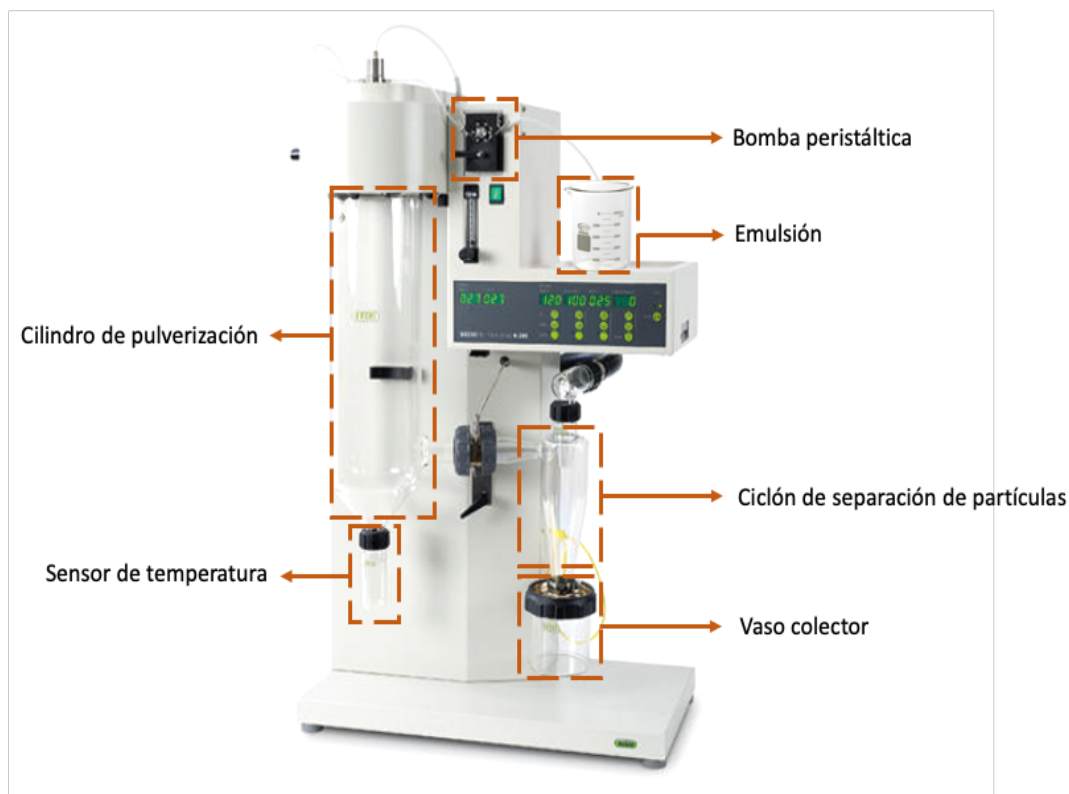
Figura 4. Secado por atomización "spray-drying" (Spray Dryer Buchi B-290).
